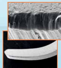
Режущая грань обычной кюреты без покрытия и увеличение под микроскопом после тестов
