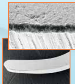
Режущая грань кюреты Sharp Diamond и увеличение под микроскопом после тестов.
